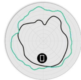
Fig 7. A770 6GHz Elevation Antenna Patterns
